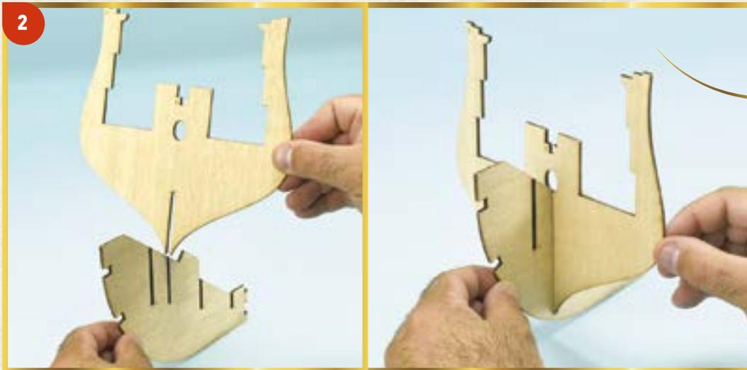
**2** Вставьте шпангоут до самого конца во второй паз килевой рамки. Перед тем как приклеить его, убедитесь, что обе детали правильно соединены друг с другом, и ознакомьтесь с инструкцией следующего шага.
