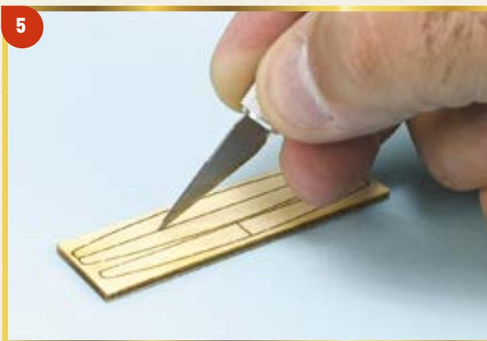
**5** С помощью острого ножа вырежьте четыре детали штока якоря.
